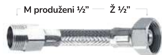
M produženi 1/2" — Ž 1/2" Duljine preko 1000 mm na zahtjev kupca. Gumena brtva je sastavni dio holenderskog priklučka Ž 1/2". Rozeta je sastavni dio inox crijeva.
